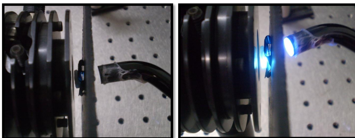
Figura 16. Avaliação da potência que atravessa blocos de dentina em Power Meter.
