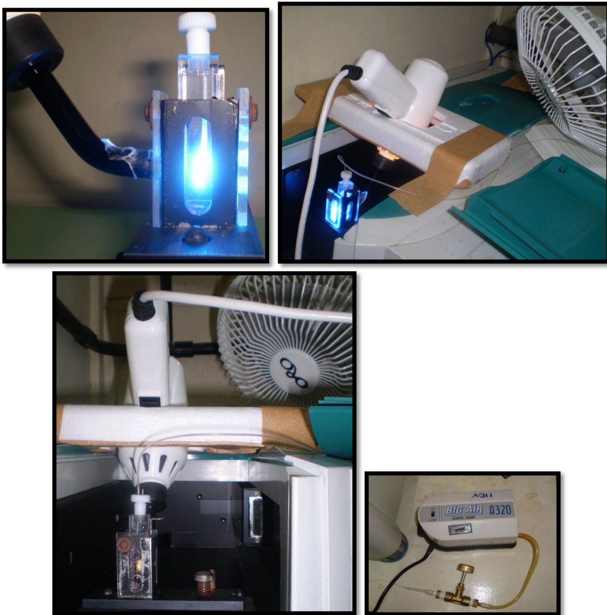
Figura 9. Espectrofotômetro adaptado para as leituras da eritrosina iluminada pelo fotopolimerizador sob ventilação adicional.
